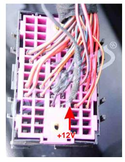
Das Gateway-Modul finden, das sich über dem Gaspedal befindet. Die Kabel löten:
